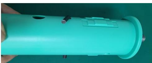
7.1.4 Установите винтовой стержень в установочное отверстие. Поворачивайте его по часовой стрелке до тех пор, пока он не будет затянут; вытащите шестигранный ключ. Вал установлен.
