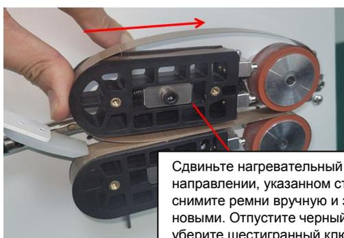
Сдвиньте нагревательный блок в направлении, указанном стрелкой, снимите ремни вручную и замените их новыми. Отпустите черный блок и уберите шестигранный ключ.
