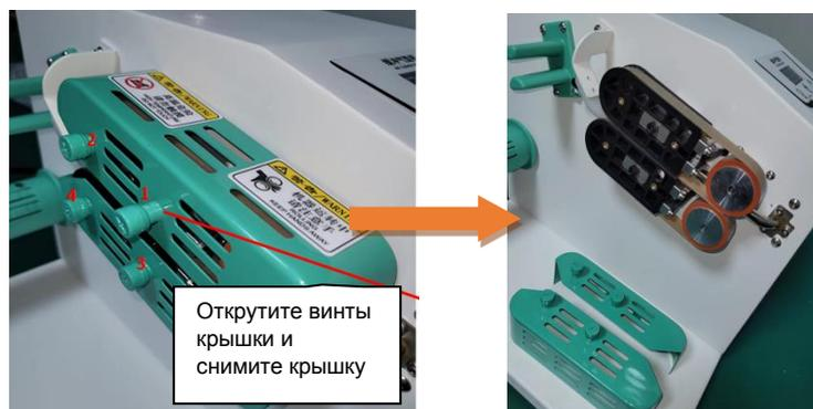
**11.3.2** Сначала надавите на нижний нагревательный блок и вставьте шестигранный ключ после выравнивания внутреннего и внешнего отверстий.
