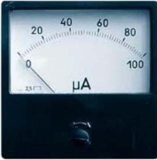
Микроамперметр М4257 предназначен для измерения тока в цепях постоянного тока радиоизмерительной аппаратуры работающей в тяжелых условиях механических и климатических воздействий. Конструкция: горизонтальное положение прибора
