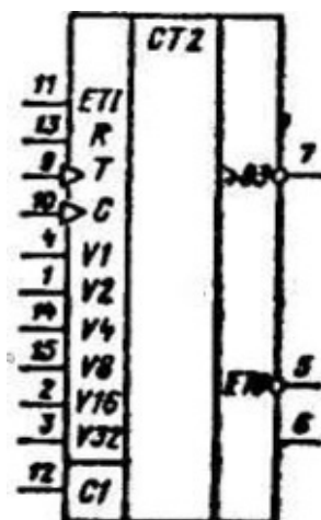
Условное графическое обозначение К133ИЕ8
