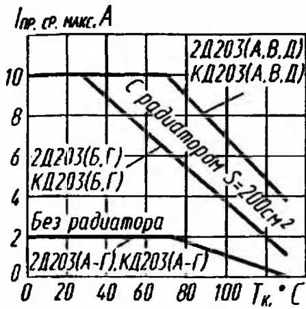
Зависимости допустимого прямого тока от температуры корпуса
