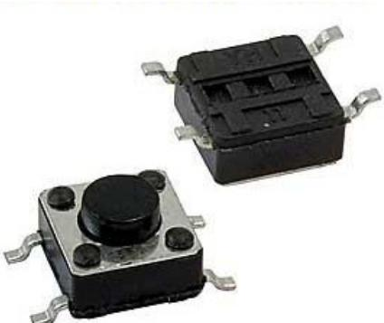
Тактовая кнопка RUICHI IT-1102W, 6x6x4.3 мм, OFF-(ON), 50 мА, 12 В, 100 мОм – это разновидность простейших механических выключателей, обеспечивающая замыкание контактов (без фиксации) только при наличии давления на поверхность штока (толкателя).
