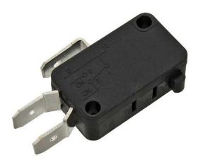
Микропереключатель RUICHI KW1-103-F, ON-(ON) SPDT, 15 A, 250 В представляет собой коммутационное устройство с механическим приводом. Он используется в качестве исполнительных устройств дистанционного управления, а также в качестве базового элемента для ряда коммутирующих изделий: кнопок, кнопочных, клавишных и других переключателей.
