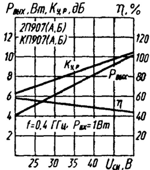
Зависимости выходной мощности, коэффициентов усиления по мощности и полезного действия от напряжения сток—исток
