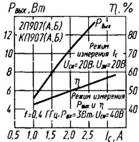
Зависимости выходной мощности и коэффициента полезного действия от тока стока
