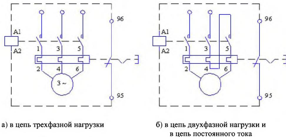
Рис. 5.4 - Рекомендуемая схема включения реле РТТ-1, РТТ-2, РТТ5-10
